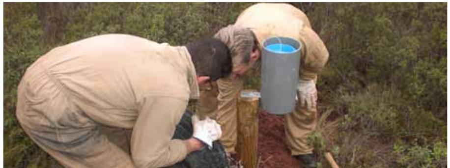
Colocación de los pluviómetros en las parcelas experimentales.
