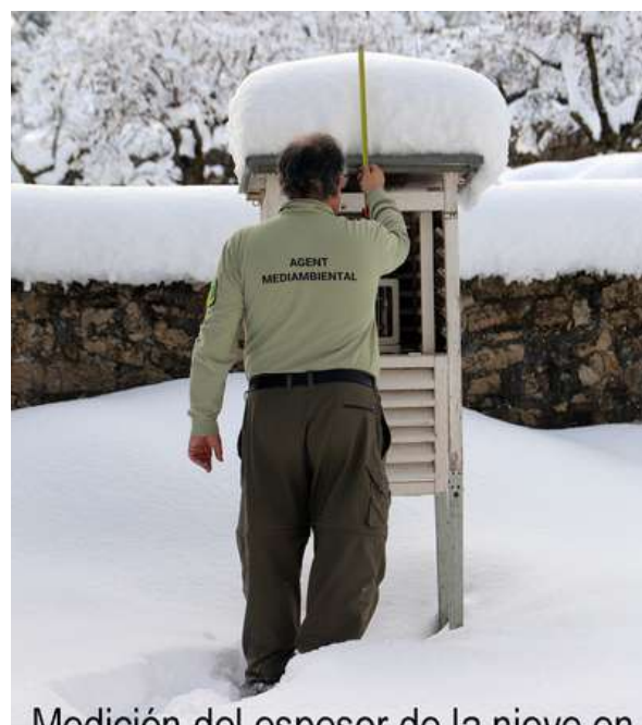
Medición del espesor de la nieve en la estación meteorológica de Aras.
