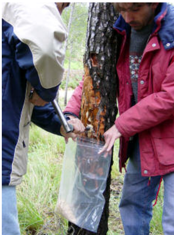
FOTO 1: Proceso de toma de muestra en el que se observa el manejo de la barrena y la bolsa de recogida de viruta.
