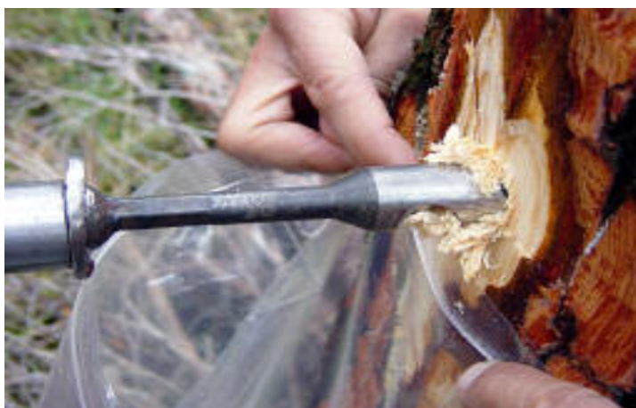
FOTO 2: Detalle de la barrena de 20 mm entrando en el árbol y la bolsa de plástico donde se recogen las virutas de madera.
